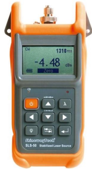
SLS-50 系列智能型稳定光源，可在多个波长上提供超稳定度的光信号，与本公司的 OPM-50 系列光功率计配合使用，能够准确测量光纤损耗，为评估光纤链路传输质量提供精确数据；也可提供精稳的调制信号，配合光纤识别器精确识别光纤。
