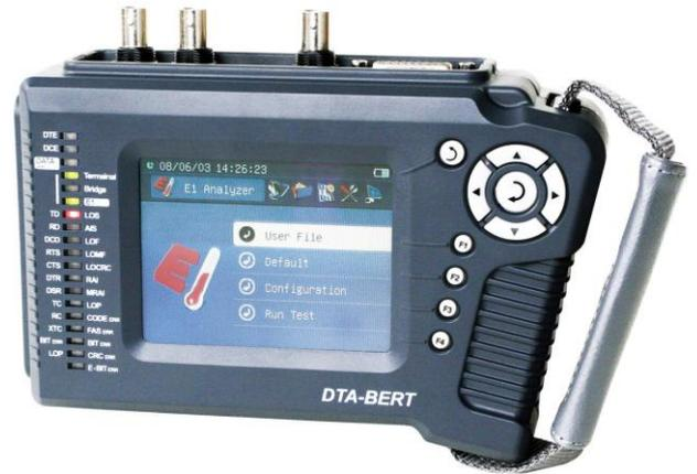
DTA-BERT 是一款配备真彩屏和全中文图形化操作界面的手持 E1/数据误码测试仪表，可用于 E1/G.703 线路的现场维护和分析，以及数据线路 (V.35, V.24/RS232, RS449, RS530, X.21) 的误码测试。DTA-BERT 功能全面，操作方便，既可按照 G.821, G.826 和 M.2100 等国际标准进行测试，也可根据用户的要求对测试数据进行存储、统计、分析和打印，是数据线路质量测试的理想工具。
