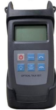
OTS-20 系列手持式多功能数字光话机是一种高效的光网络工程作业工具，具有数字语音编解码、全双工通话、智能化、多功能等特点。
