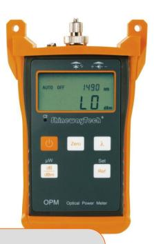
OPM-15 掌上型光功率计采用先进精密激光探测与处理技术,具有高精度的测试品质,可广泛应用于实验室及局域网、广域网、城域网、CATV 或长途光纤网络等各种测试场合。简练的功能键设计使您可以方便地实施快速测试。与本公司的 SLS 系列稳定光源配合使用,可精确测量光纤的损耗,评估光纤链路的传输质量。
