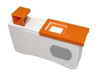
FCT-5 光纤接头清洁带是维护和保证光纤连接质量最重要和必不可少的配件,使用它可以简单,快速地清洁各种适配器的光纤连接器端面,它是最佳的非酒精清洁方法。FCT-5 是一款适合光纤连接器插芯端面清洁的清洁器,它简单易用,可替换清洁卷带,并且提供低成本清洁。适用的连接器型号有: SC, FC, MU, LC,ST, D4, DIN 等。
